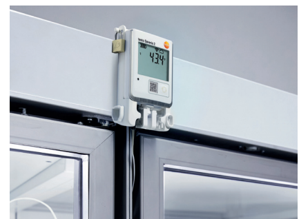
Bewaking van ultradiepvriezers in het laboratorium (testo Saveris 2-T3 met temperatuurvoeler)
