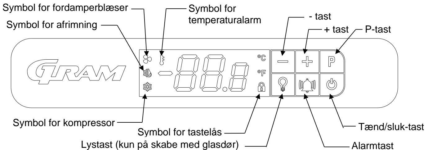
Når produktet tilsluttes strøm, gennemløber det en kort opstartssekvens. I løbet af denne tændes alle lyssegmenter i displayet.
