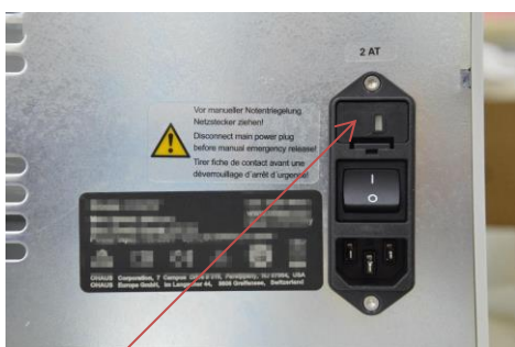
Cassetto portafusibili con fusibile 4 AT
