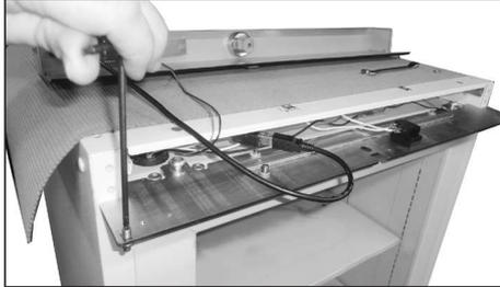
13. Tighten pivot (2,5 mm allen key)
