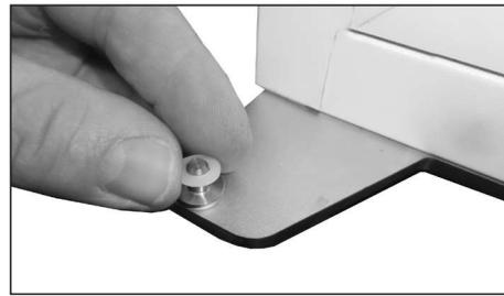
28. Die Kunststoff-Unterlegscheibe des Türzapfens neu ausrichten.
