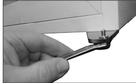
20. Mutter des unteren Drehzapfens lösen.
