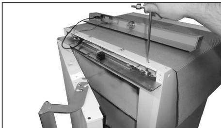
39. Die beiden M8-Schrauben der oberen Halterung festziehen.
