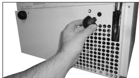
2. Anschließend die identische Bohrung auf der rechten Seite der Motorabdeckung suchen und die letzte Schutzabdeckung in diese Bohrung drücken.
