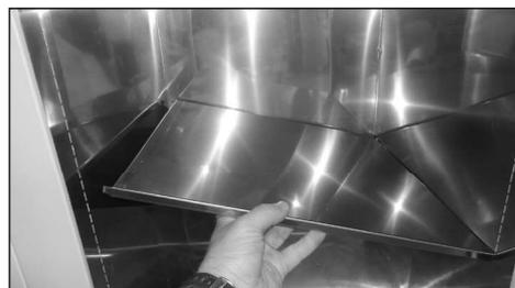
Den Einlegeboden anheben, um alle Haken zu lösen, und dann auf eine Seite ziehen. Den Einlegeboden anschließend auf der freien Seite nach oben neigen und herausheben.
