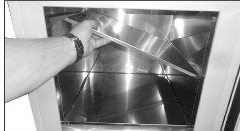
2. Eine Seite der Einlegeboden-Haken in der neuen Höhe positionieren
