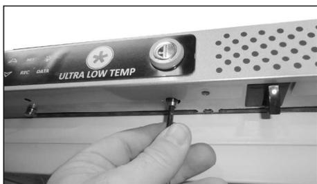
5. Sicherungstift entfernen (mit 4 mm Inbusschlüssel)
