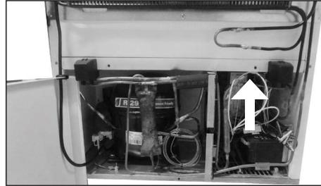
2. Die Abdeckung neben dem Gefriergerät ablegen. Die Kabel müssen noch angeschlossen sein.
