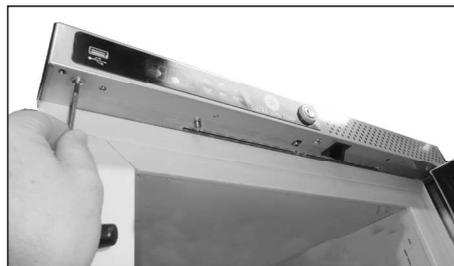
4. Die drei Schrauben unter der Bedientafel entfernen (mit 3 mm Inbusschlüssel)
