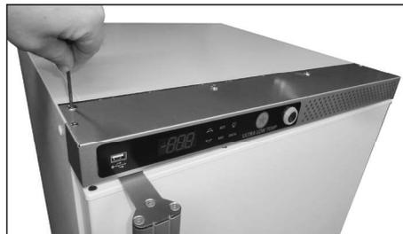
2. Die sichtbaren Schrauben auf der Oberseite lösen und entfernen. (dazu Inbusschlüssel mit 3 mm und Torx-Werkzeug Größe 20 verwenden)
