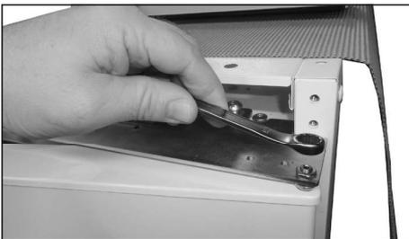
9. Mutter des Drehzapfens lösen (mit 10 mm Schraubenschlüssel)
