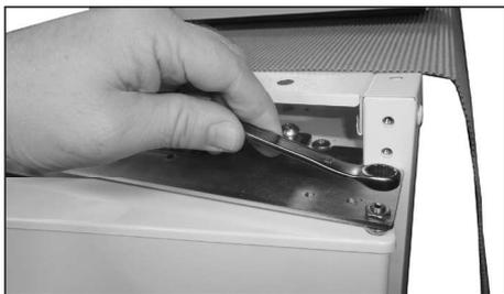
9. Loosen pivot nut (use 10 mm spanner)
