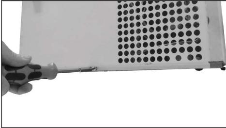
1. Die 3 Schrauben in der Abdeckung des Kompressorfachs lösen und die Abdeckung entfernen.
