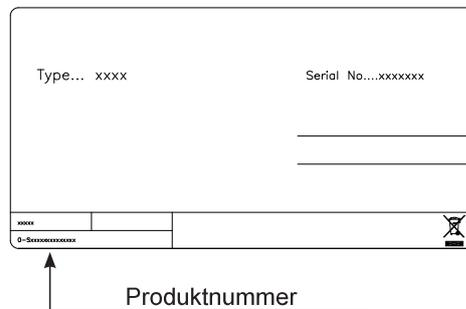
Das Typenschild enthält verschiedene technische Angaben, u.a. auch Typ- und Seriennummer. Denken Sie daran! Stets nur autorisierte Handwerker zu beauftragen, wenn ein Teil repariert oder ausgewechselt werden muss!
